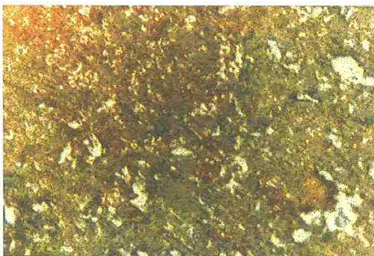
Figura 8: Microscopia Óptica (Cal+Hematita) - Aumento 250x
