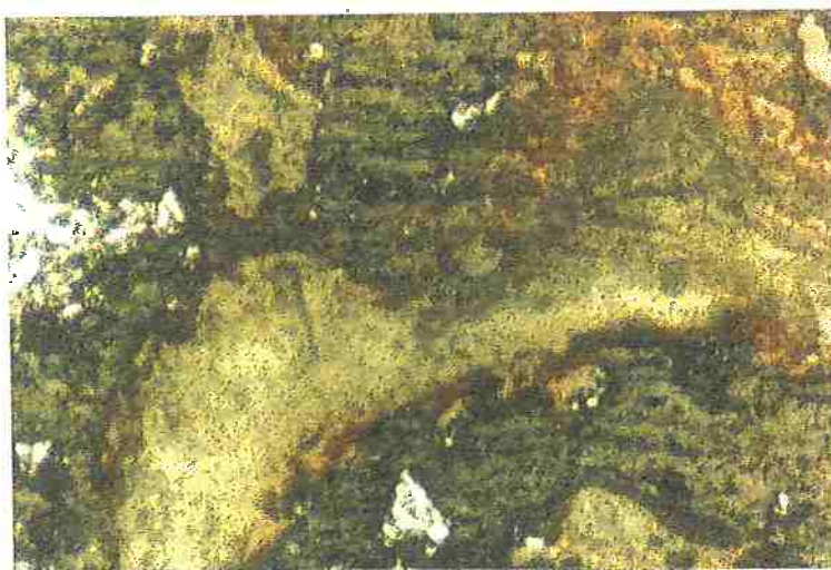
Figura 17: Microscopia Óptica - 250x - FeO+Silica
